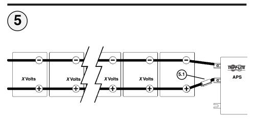
See Battery Connection, Pg.8. 5.1 is the fuse. X = Your APS's Inverter's Nominal Input Voltage. (See specs.) Refiérase a la sección "Conexión de Baterías", página 23. 5.1 representa el fusible. X = El Voltaje Nominal de Entrada del Inversor del APS. (Vea las especificaciones).
